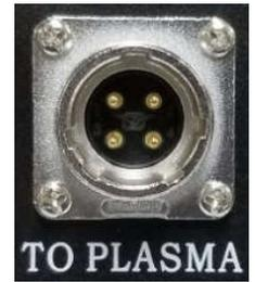
XPTHC-100V 必须采样等离子电弧电压来调整割枪高度, 等离子弧电压就是电极和工件之间的电压, 切割时弧电压绝对值一般大于 100V, 由于电压较高, **调高器接入的弧压信号必须为经过分压板分压后的弧压信号, 弧压值最大不能超过 5V, 切记不可将实际弧压从此航插接入到调高器, 否则必会损坏电路板, 造成无法维修的破坏!**
