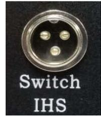
当使用普通触点开关时，只需将连接第 1 脚（COM）与第 2 脚（Signal）连接到开关两端即可。如使用接近开关，XPTHC-100V 调高器只能接收 NPN 型接近开关信号，出厂默认使用 NPN 常开型接近开关。
