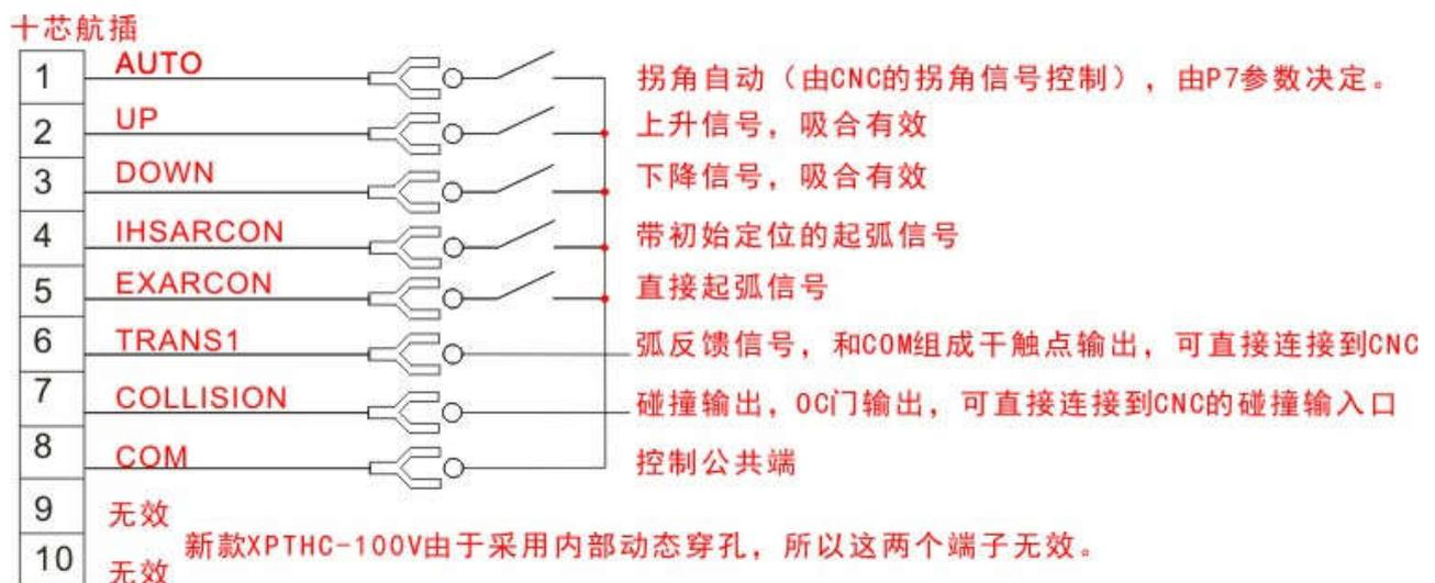
图 4-4 TO CNC 数控接口电路原理
