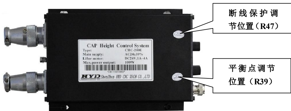
图 4-3 断线保护和平衡点调节位置
