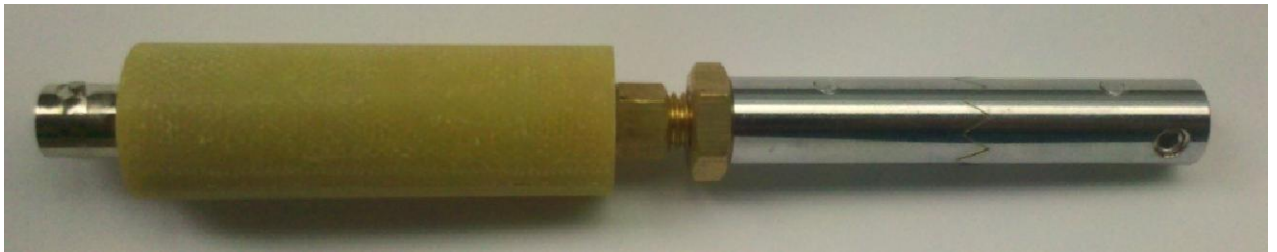
图 2-4 安装柄及弹性连接器
